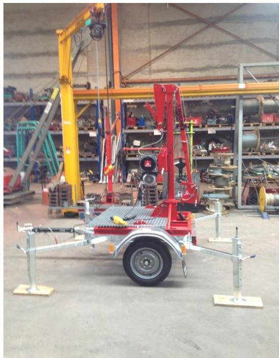
. **Etape 3** : assurer la bonne mise à niveau de l'ensemble, dévers « 0 » (un niveau à bulle est fixé au centre de la plateforme et visible à travers le caillebotis métallique : la bulle doit être centrée).
